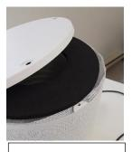
3. REMOVE THE BOTTOM COVER AND THE FOAM GASKET
